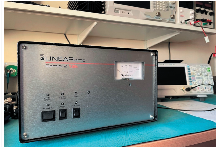
Рис. 4. Підсилювач потужності Gemini 2-1.2K VHF від DX Shop, який може використовувати BLF188XR або ART1K6FE
