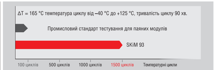
Рис. 4. Використання блоків на основі модулів SKiM 93 призводить до збільшення терміну використання обладнання
