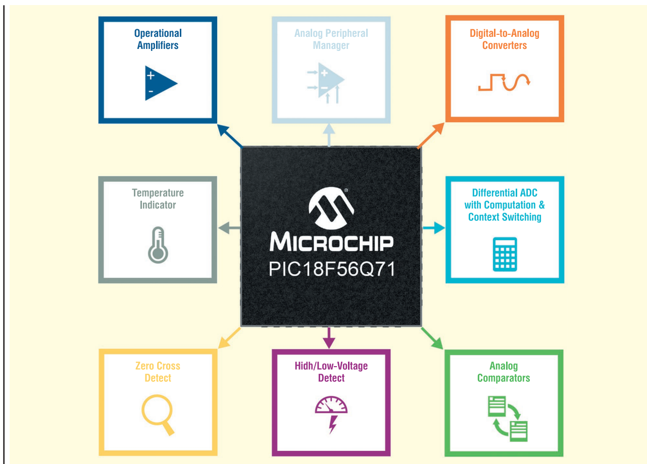
Рис. 1. Мікроконтролери з аналоговими периферійними пристроями
