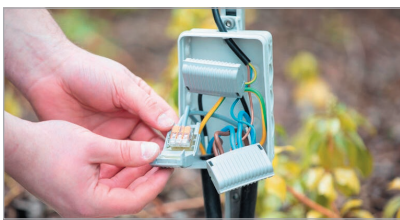
Рис. 4. Використання WAGO Gelbox в монтажних коробках разом зі з'єднувачами. Тільки така комбінація забезпечує подвійну ізоляцію кабелю для захисту від ураження електричним струмом
