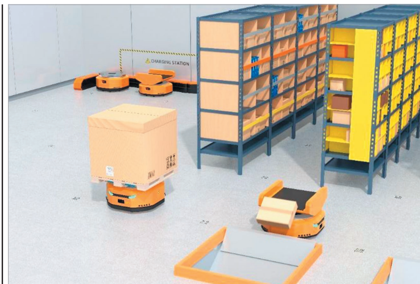
Рис. 3. Бездротове заряджання мобільних роботів в цеху
