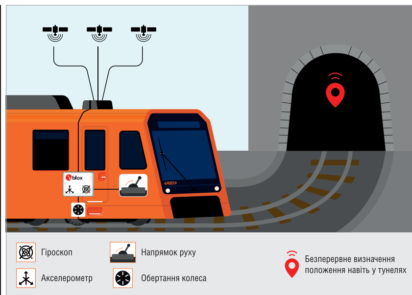
Рис. 1. GPS-приймач, що використовує сигнали про обертання коліс та напрямок руху
