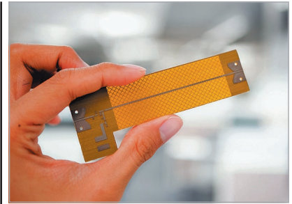
Рис. 3. РЧ-підсилювач, надрукований за допомогою системи DragonFly Pro
