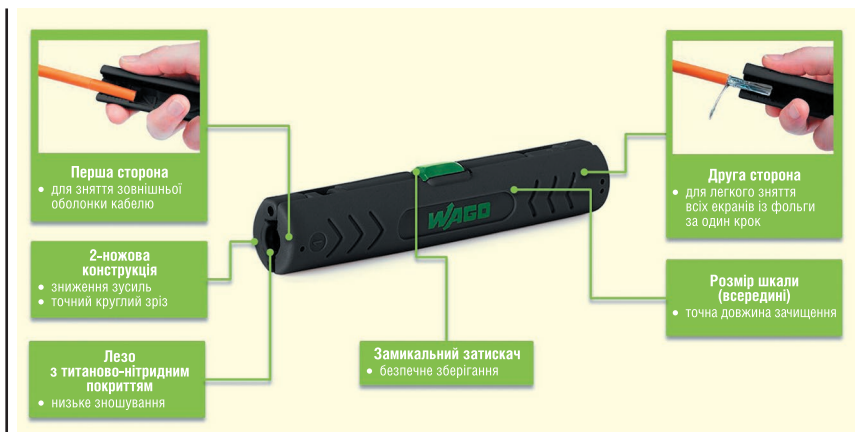
Рис. 2. Стрипер для кабелю передавання даних (206-1451); Ø 4.5–10 мм
