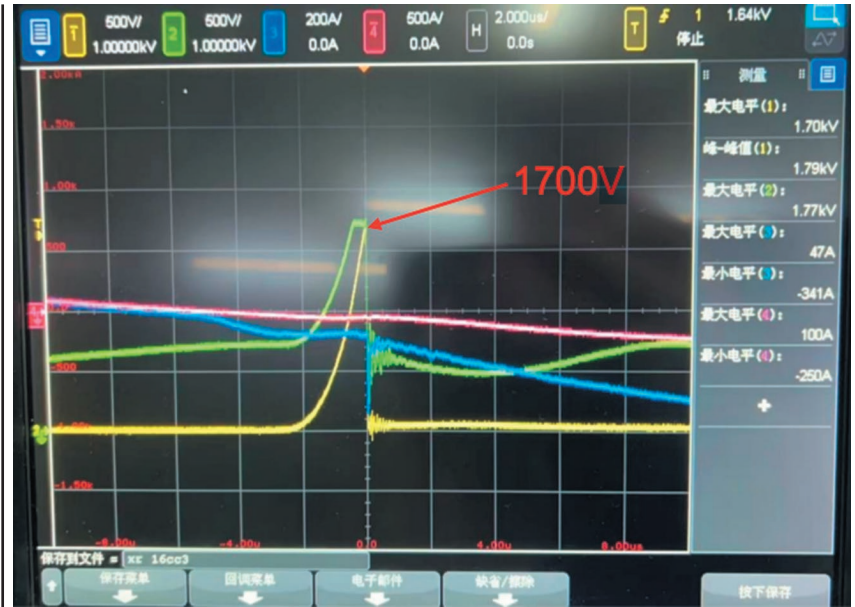
Рис. 2. Імпульс напруги 1700 В, виміряний на зарядній станції для електромобілів
