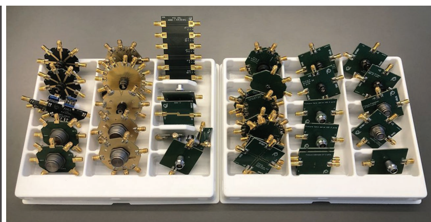
Рис. 5. Приклади пристосувань для друкованих плат, що використовуються для вимірювання за допомогою векторного аналізатора кіл
