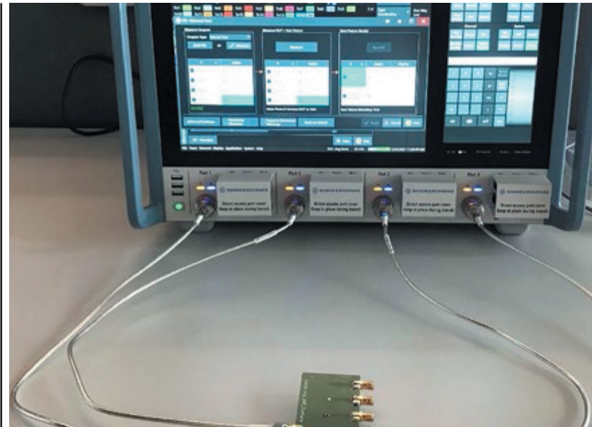
Рис. 4. Векторний аналізатор кіл для вимірювання параметрів зв'язку у частотній області
